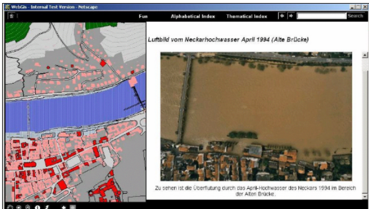
Abbildung 1: Hochwasserinformation im Deep Map WebGIS - Die Karte zeigt die Ausdehnung des Neckarhochwassers vom April 1994 (senkrechte Schraffur), rechts das zugehörige Luftbild.
